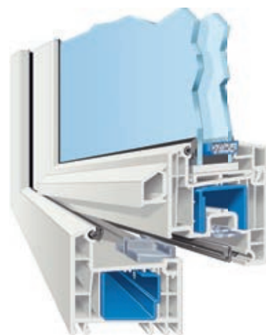
Systemschnitt Castello flächenversetzt
